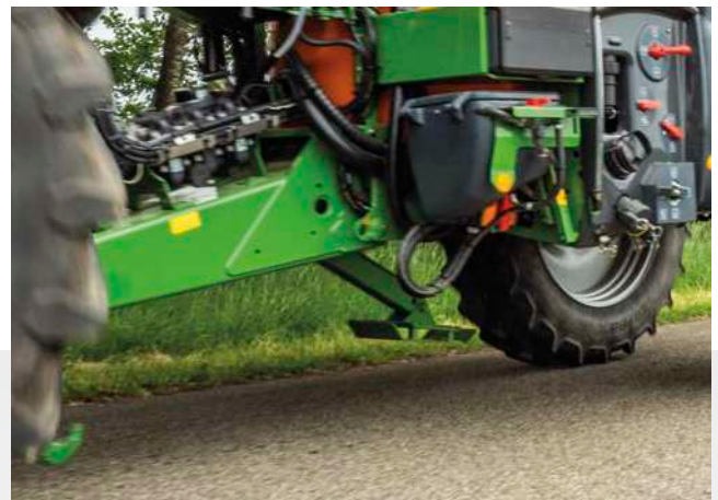
Untenanhängung mit hydraulischem Stützfuß
