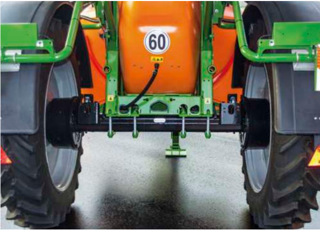
Festachse mit Spurweiten von 1,50 m bis 2,25 m
