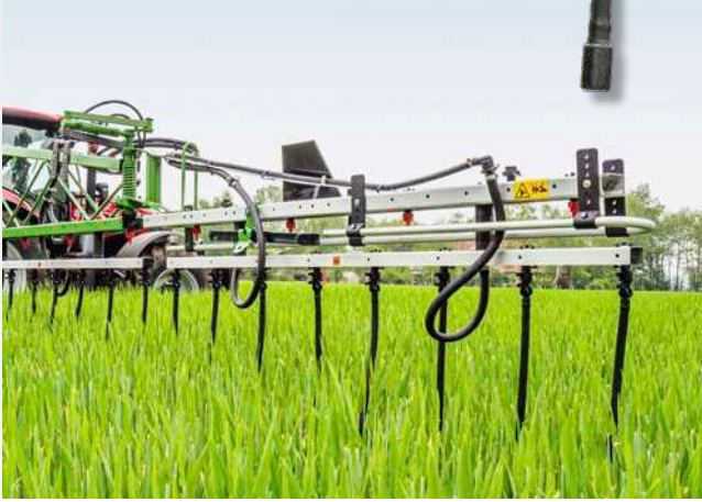
Schleppschlauchverband am Super-S2-Gestänge
