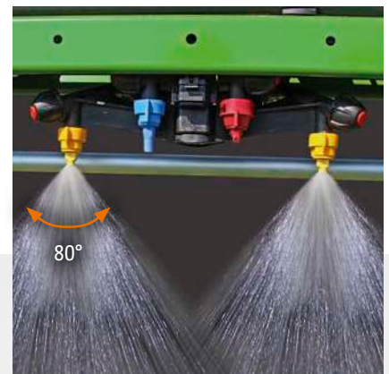
Elektrische Einzeldüsensteuerung AmaSelect mit 4-fach-Düsenträger und 50-cm- oder 25-cm-Düsenabstand
