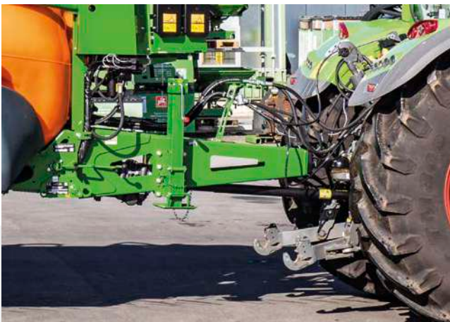
Obenanhängung mit Zugkugelkupplung und mechanischem Stützfuß
